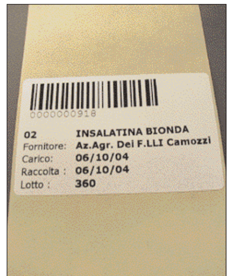
Figura 7 - Computer palmare utilizzato alla linea di trasformazione, dotato di lettore bar code di tipo laser e predisposto per la connessione alla rete aziendale mediante sistema wireless (figura a), e relativo codice a barre da applicare al prodotto (figura b), utilizzati per l'identificazione univoca dei lotti aziendali.
